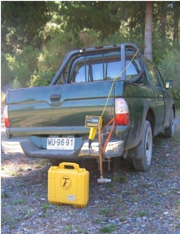
Figura 3-m: Montaje equipo DustMate – Domínguez, 2006
