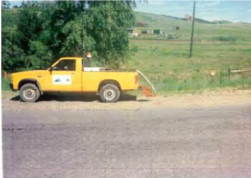
Figura 2-e: Disposición del Polvometro en Vehículo de Prueba - Sanders y Addo, 2000
