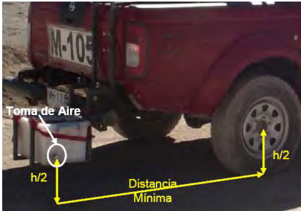
Figura 2-k: Ubicación del MPC-1 en camioneta - Bellolio, 2005
